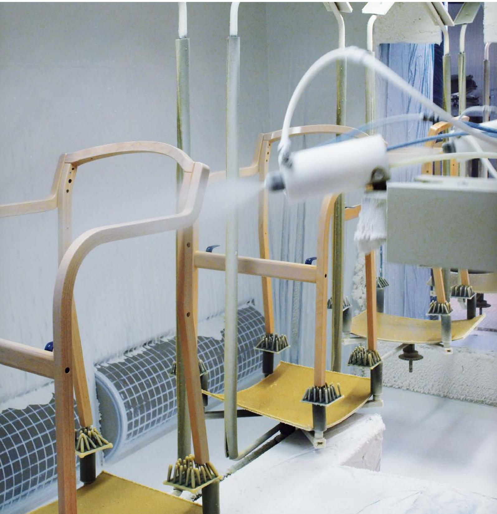
» Les excédents de peinture **sont récupérés** et, après un retraitement, sont réintégrés au cycle de la chaîne de peinture. Nous diminuons ainsi **au maximum** les déchets de peinture.
